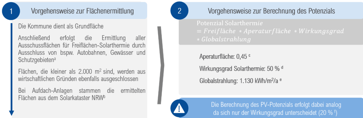
Abbildung 24: Vorgehensweise zur Ermittlung von Solarpotenzialen.
